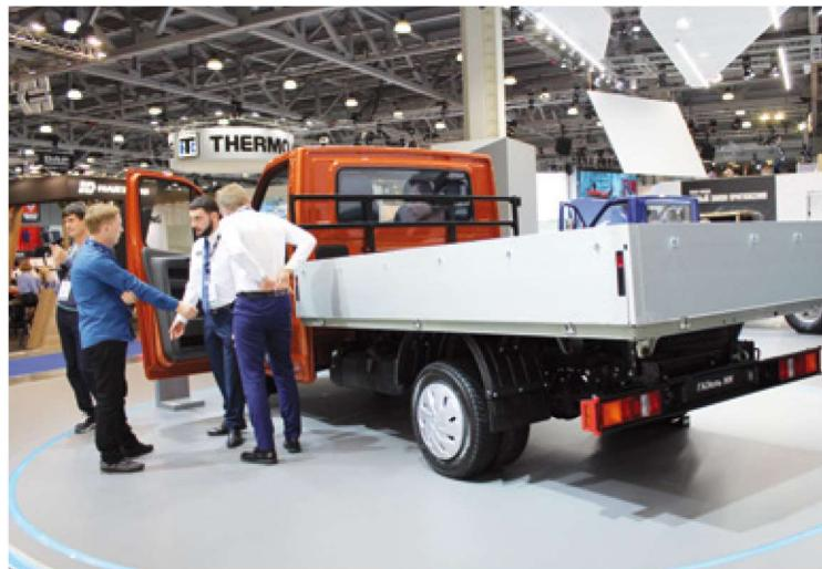
часто жаловались водители, эксплуатирующие машины в грязи. А в остальном, «коренастый крепыш» выглядит внушительно: подвеска, рулевое управление и кабина от «ГАЗона Next», клиренс 315 мм, блокировка двух дифференциалов, пневматические тормоза, подкачка шин, турбодизель ЯМЗ-534 мощностью 149 л. с. Интересно, что для управления раздаткой предусмотрены кнопки на приборной панели. Розничная цена в базовой комплектации — 2 195 000 рублей.
