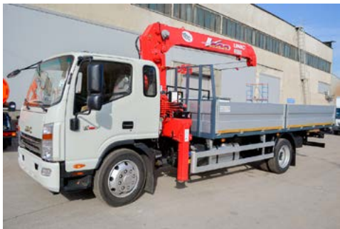
▲ Бортовой грузовик с тросовой КМУ Unic на шасси JAC N120, «РусТрак»
