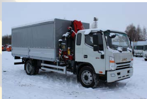
▲ Тентованный бортовой автомобиль с КМУ Fassi на шасси JAC N120, AM3
