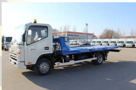
▲ Эвакуатор повышенной вместимости на шасси JAC N75, AM3
