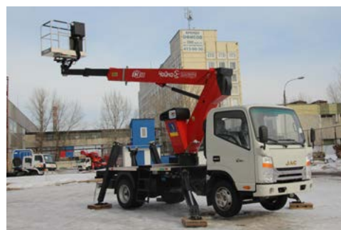
▲ АГП Чайка-Socage T318 с задним расположением люльки на шасси JAC N56, «Чайка-Сервис»
