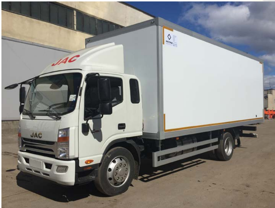
▲ Фургон-рефрижератор на шасси JAC N120, «РусТрак»
