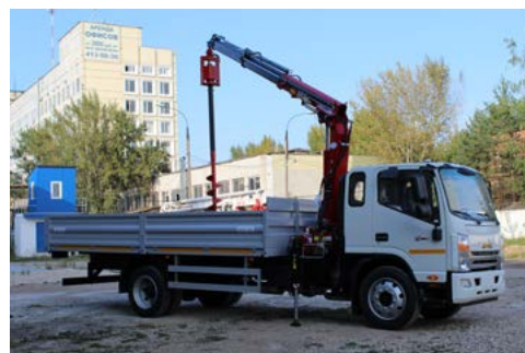
▲ Бортовой автомобиль с КМУ Чайка-Атсго Veba 811Т и буром на шасси JAC N120, «Чайка-Сервис»
