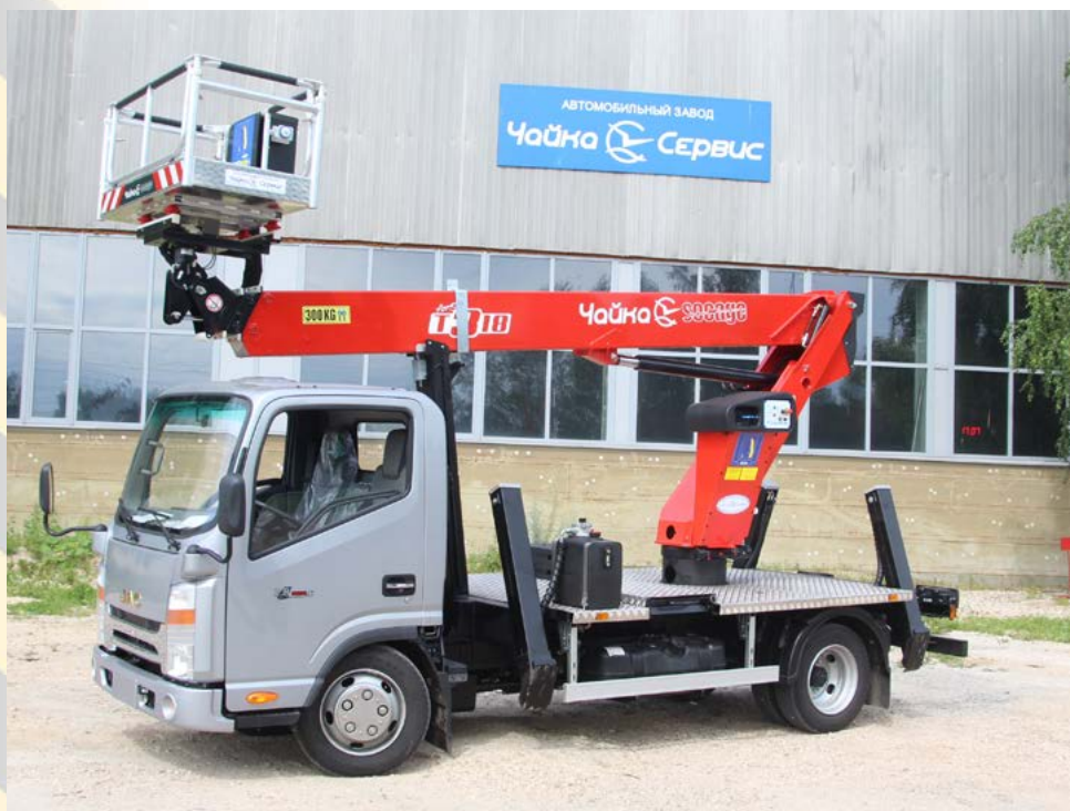
▲ АГП Чайка-Socage T318 с передним расположением люльки на шасси JAC N56, «Чайка-Сервис»
