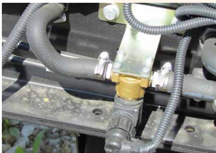
Для повышения прочности рама изготовлена по принципу «лонжерон в лонжероне». Вся проводка – с внешней гофрированной оплеткой
